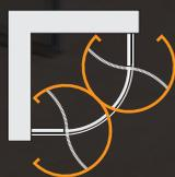
rahmenlos, für Ecke, mit 2 Pendeltüren und 2 festen Segmenten, Türbeschlag an den festen Segmenten, nach innen und außen zu öffnen, Beschlag rund, Größe 1000 x 1000 mm, Radius 500 mm, Höhe 2000 mm, Sonderhöhen auf Anfrage
